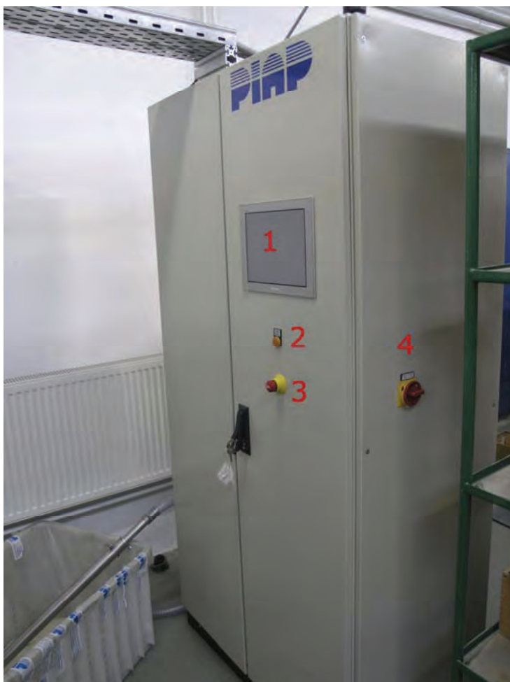
Fot. 3. Szafa sterownicza stanowiska. 1 – panel operatorski, 2 – kontrolka zasilania, 3 – przycisk Stopu Awaryjnego, 4 – włącznik główny
