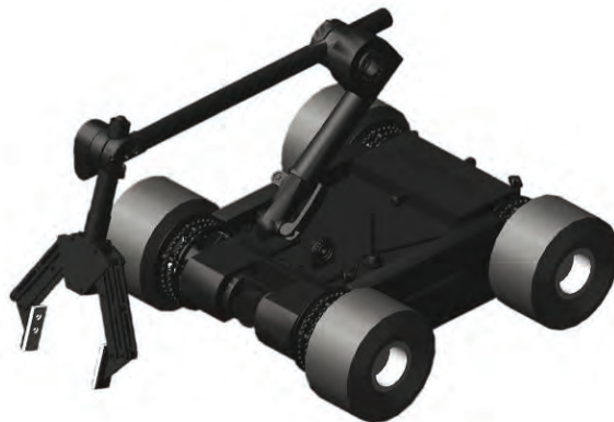
Rys. 4. Model symulacyjny małego robota do rozpoznania terenu w programie MD Adams
