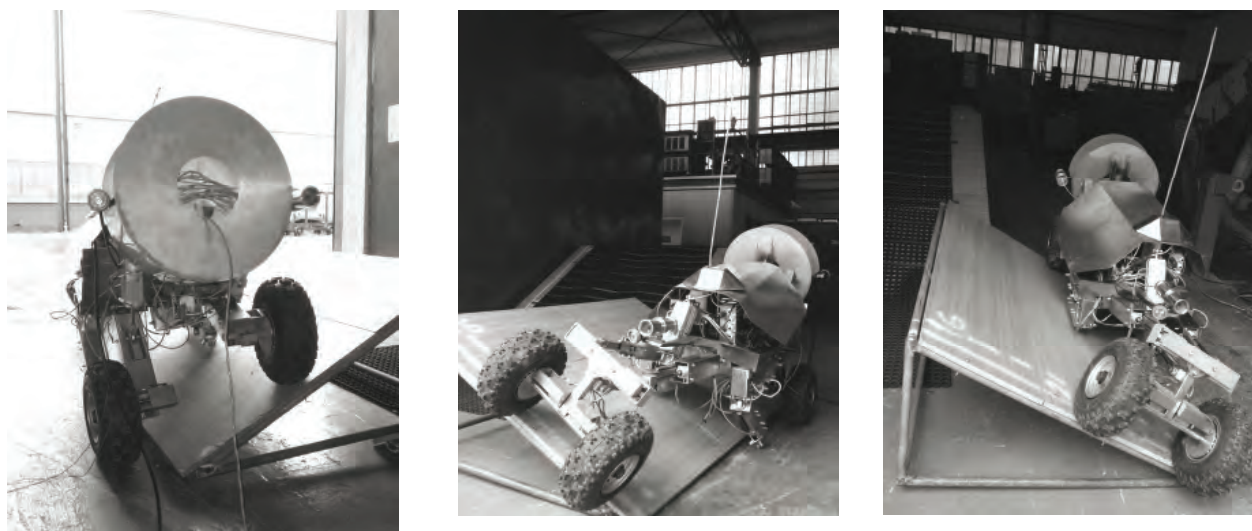
Rys. 8. Przejazd przez boczną rampę o nachyleniu 30^\circ
