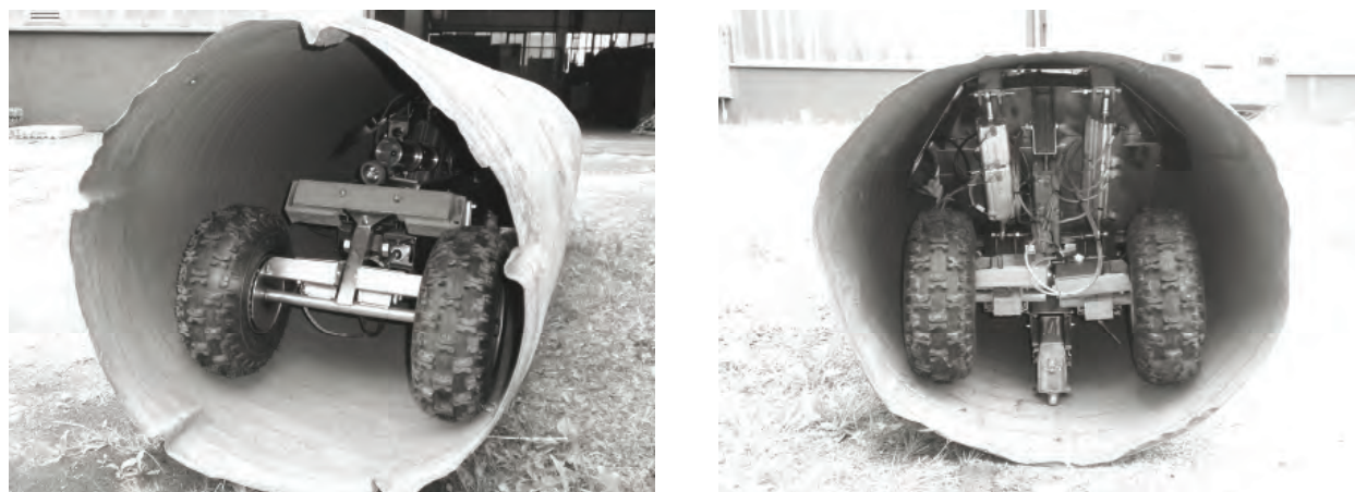
Rys. 9. Transport robota przez lutnię o średnicy 800 mm
