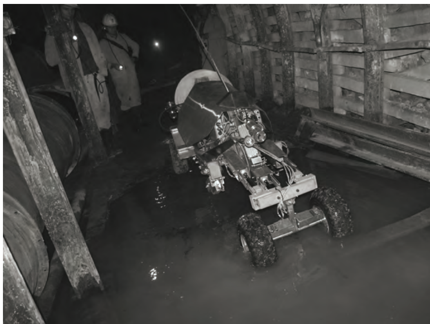
Rys. 10. Przejazd robota w wyrobisku górniczym przez miejsce zawadnione o głębokości ok. 20 cm
