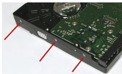
Fot. 3. Rozmieszczenie otworów montażowych w chassis dysku, wraz z widoczną elektroniką
