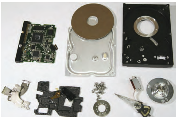
Fot. 2. Wydzielone podzespoły dysku po pełnym demontażu
