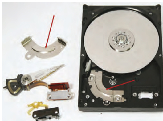
Fot. 5. Widok podzespołów dysku w trakcie demontażu – strzałka wskazuje magnesy
