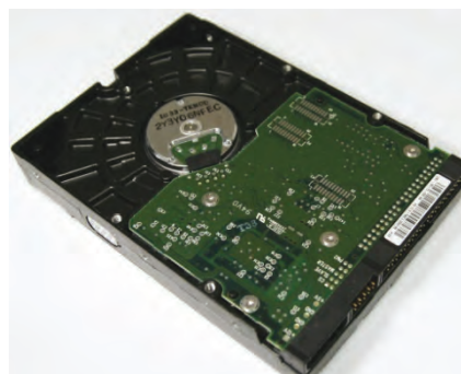
Fot. 1. Przykładowy dysk HDD 3,5"; widok od strony elektroniki
