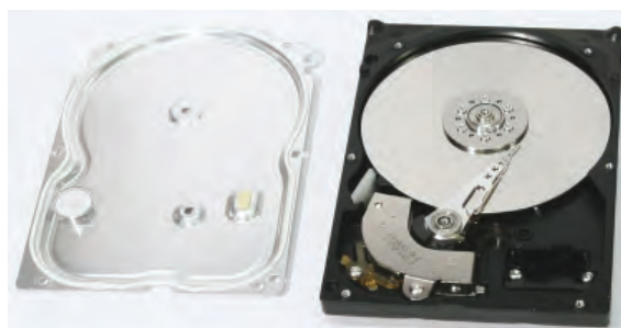
Fot. 4. Widok podzespołów dysku po usunięciu blachy wierzchniej i elektroniki
