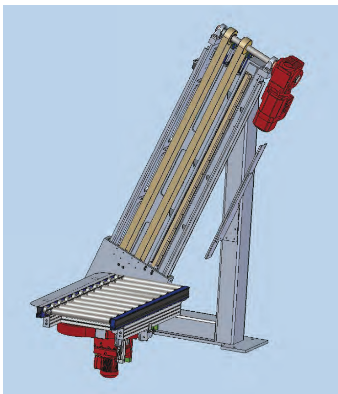
Rys. 10. Pionowy system transportu z napędem elektrycznym
