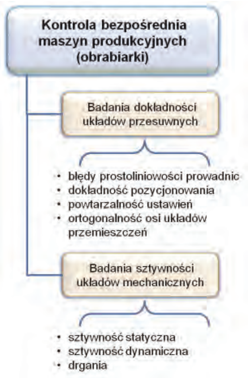
Rys. 2. Ogólny zakres kontroli bezpośredniej maszyn technologicznych Fig. 2. General scope of direct technological machines control
