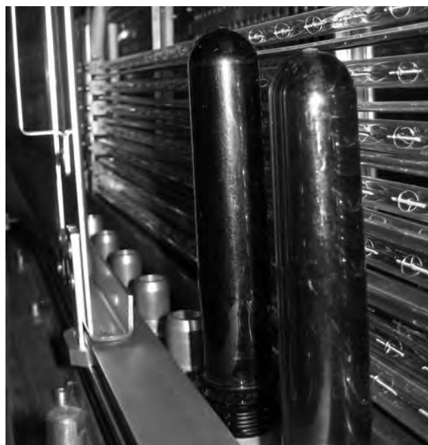
Rys. 1. Widok wnętrza zespołu ogrzewającego preformy
