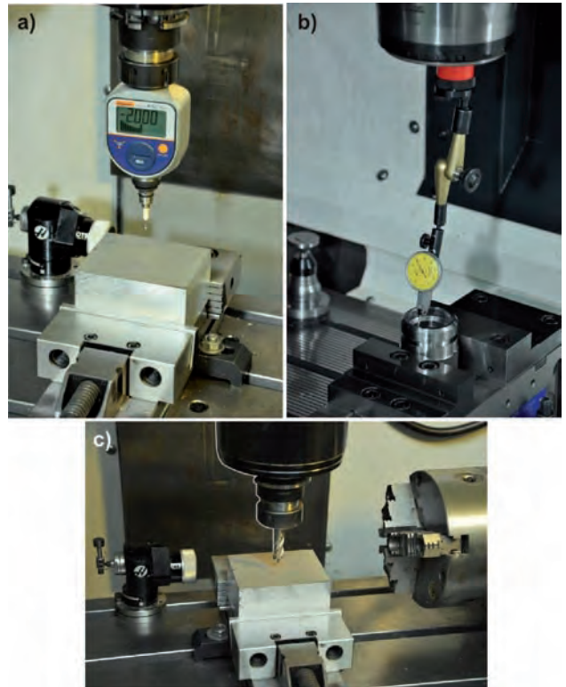
Rys. 6. Przykłady pomiarów ręcznych- wyznaczanie punktu zera przedmiotu: a) czujnikiem krawędziowym, b) czujnikiem dźwigienkowym, c) narzędziem
