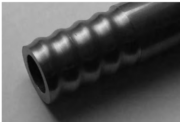
Rys. 6. Gwint falisty wykonany na tokarce uniwersalnej Fig. 6. Rope thread made on the standard lathe
