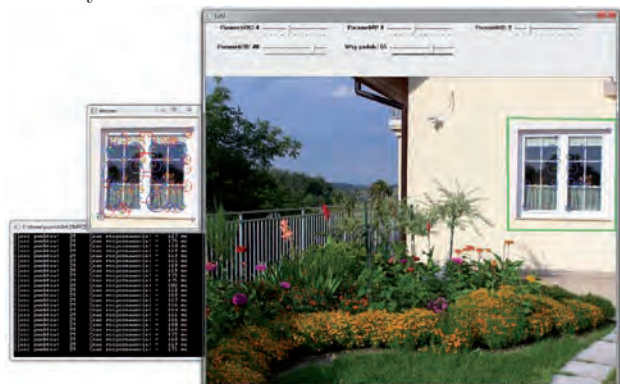
Rys. 8. Rozpoznawanie obrazu za pomocą sekwencyjnego algorytmu SURF uruchamianego na CPU
