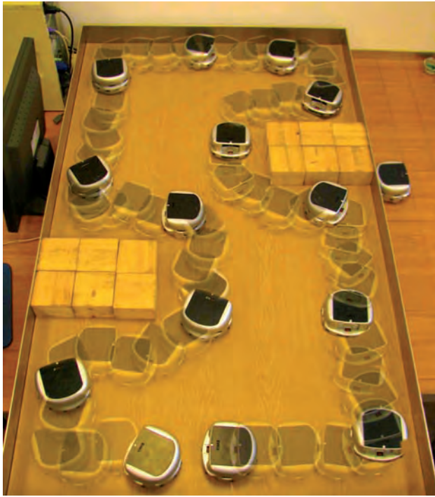
Rys. 7. Ilustracja działania robota Khepera III (algorytm Braitenberga)
