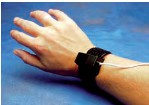
Rys. 2. Czujnik przyspieszenia (źródło: BIOPAC Systems Inc, www.biopac.com )
