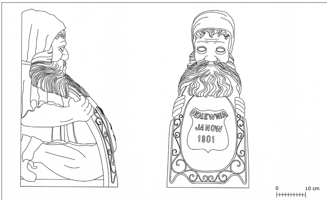
20. Warszawa, ul. Mokotowska 57, kamienica (1901), odboje żeliwne w formie krasnali przy narożach przejazdu bramnego. Pomiar ZHAP WAPW, 2007
