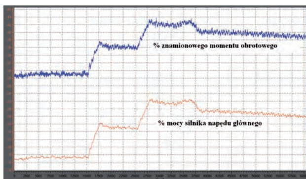
Rys. 1. Przebieg momentu obrotowego i mocy silnika napędu Fig. 1. Torque and Power characteristics of main spindle drive
