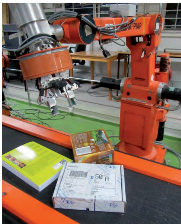
Rys. 1. Manipulator IRp-6 w trakcie identyfikacji produktów Fig. 1. The IRp-6 manipulator during products identification
