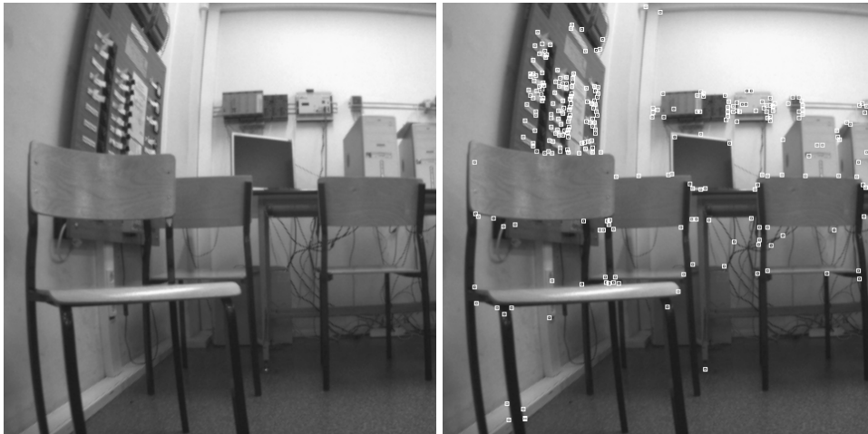
Rys. 3. Prezentacja działania sprzętowej implementacji algorytmu detekcji cech punktowych FAST – po lewej obraz oryginalny, po prawej obraz z naniesionymi wykrytymi cechami
