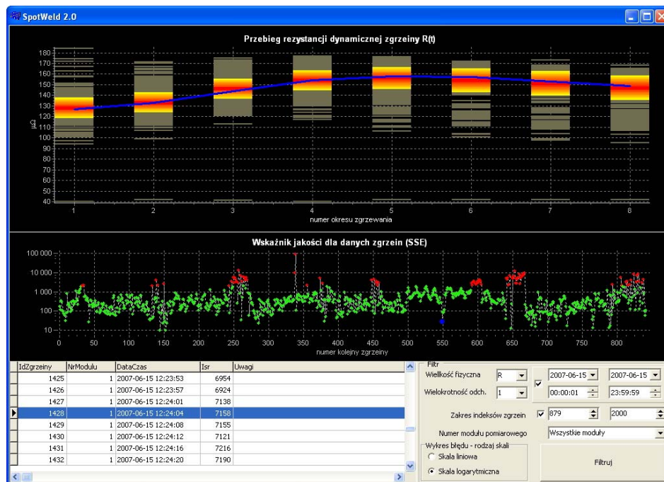
Rys. 2. Interfejs aplikacji użytkownika - przykładowy przebieg procesu zgrzewania
