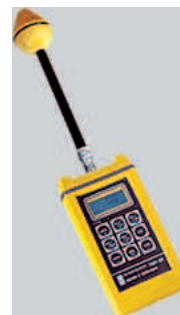
Fot. 3. Jeden z mierników natężenia pola elektrycznego w paśmie od 100 kHz do 3 GHz (wg [14])
