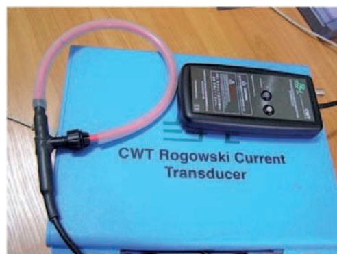
Rys. 6. Cewka Rogowskiego z integratorem do pomiarów prądu w obwodach do 10 kV
