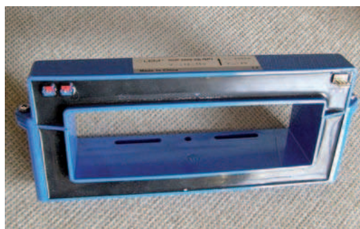
Rys. 7. Przetwornik pomiarowy prądu LEM z możliwością rozmontowania obwodu magnetycznego
