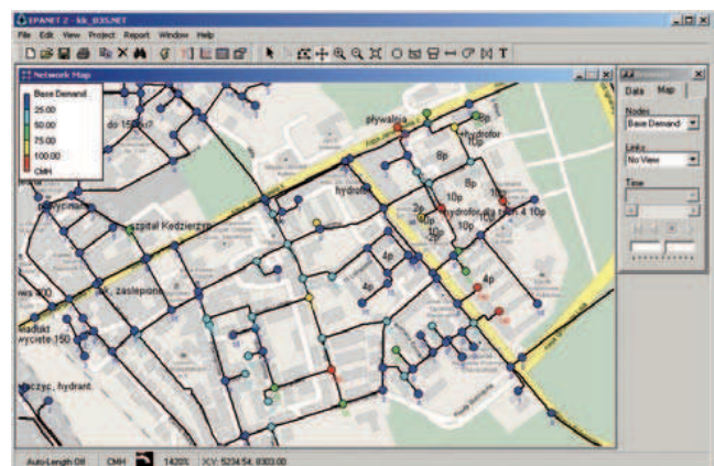
Rys. 2. Model symulacyjny po wprowadzeniu bazowych wartości zapotrzebowania dla odbiorców
