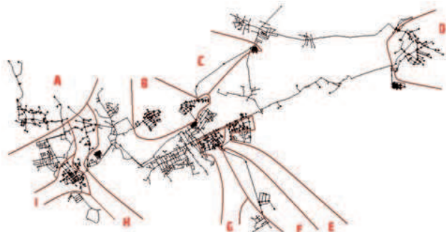
Rys. 11. Sieć z podziałem ze względu na wartość parametru emitters wyznaczonego przez algorytm genetyczny
