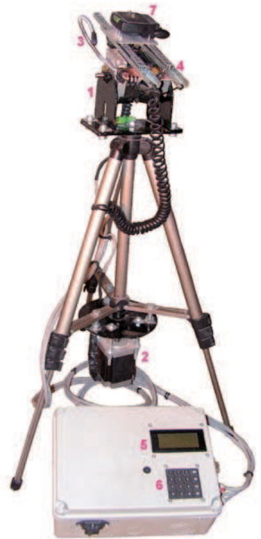
Rys. 1. Prototyp urządzenia do zautomatyzowanego wykonywania zdjęć do tworzenia panoram (1 – silnik krokowy, 2 – silnik krokowy, 3 – dioda nadawcza wyzwalacza optycznego, 4 – wskaźnik laserowy, 5 – wyświetlacz LCD, 6 – klawiatura, 7 – mechanizm mocowania aparatu)
