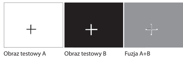
Rys. 11. Efekt fuzji niskoinformacyjnych obrazów testowych
