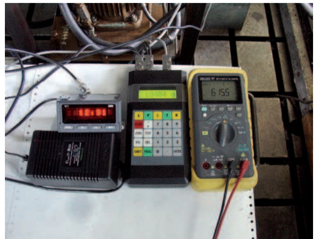
Rys. 8. Fotografia części pomiarowo-sterującej stanowiska do wzorcowania przetworników indukcyjnych. Zdjęcie wykonane w Przemysłowym Instytucie Maszyn Budowlanych w Kobylce. Pierwszy z lewej – inteligentny przetwornik strumienia
