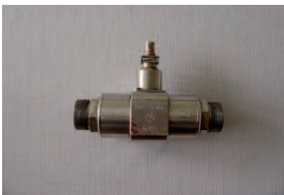
Rys. 2. Fotografia generacyjnego indukcyjnego turbinkowego czujnika pomiarowego strumienia objętościowego typ PMB-6000 produkcji Instytutu Lotnictwa w Warszawie
