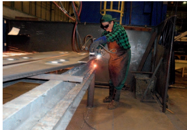
Rys. 4. Tradycyjne stanowisko ukosowania ręcznego – operator podczas pracy
