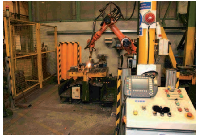
Rys. 2. Zrobotyzowane stanowiska ukosowania z technologią cięcia tlenowego wykorzystujące roboty KR 16 firmy KUKA
