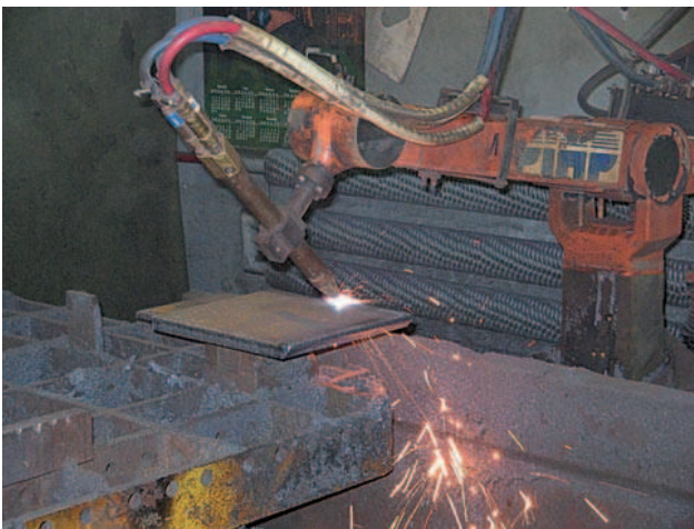
Rys. 1. Pierwsze zrobotyzowane stanowisko ukosowania blach z wykorzystaniem robota URP-6
