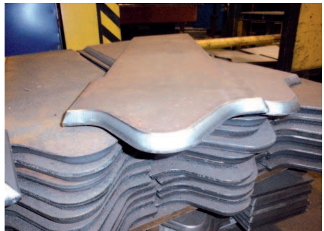
Rys. 7. Przykładowy detal po ukosowaniu metodą cięcia plazmowego na stanowisku zrobotyzowanym
