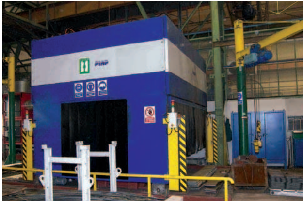
Rys. 5. Zrobotyzowane stanowisko ukosowania blach metodą cięcia plazmowego z wykorzystaniem robota KR 60 firmy KUKA – widok ogólny
