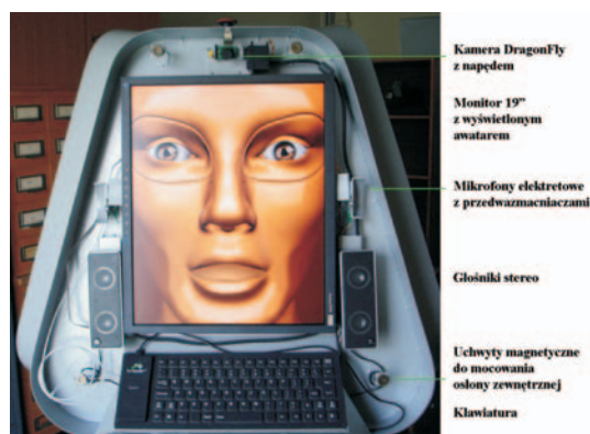
Rys. 4. Monitor z wyposażeniem dodatkowym wewnątrz osłony, zawieszony na kolumnie napędowej
