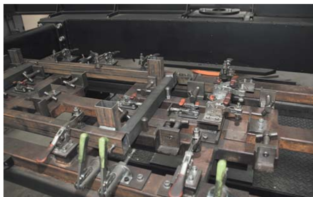
Ilustr. 7. Rama po spawaniu, zamocowana na przyrządzie
