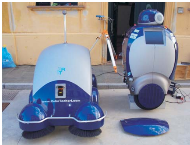
Projekt DustBot, finansowany przez Komisję Europejską, miał za zadanie doprowadzić do opracowania i przetestowania zespołu robotów współpracujących ze sobą przy porządkowaniu przestrzeni miejskiej.
