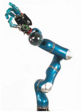
Gibka konstrukcja manipulatora KUKA LWR – Light Weight Robot
