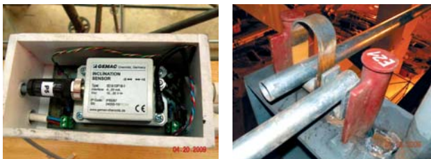
Rys. 3. Czujnik odchylenia kąowego z układem automatycznej stabilizacji temperatury w obudowie atermicznej oraz realizacja belek pomiarowych na obiekcie
