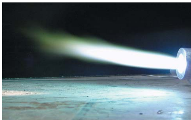
Strumień plazmy w powietrzu wytwarzany w plazmotronie łukowym 1)
