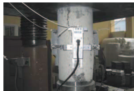
Tensometryczny czujnik przemieszczeń umieszczony na zniszczonej próbce
