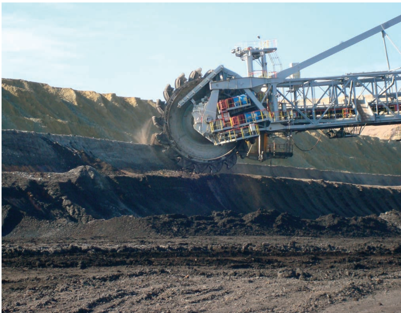
Selektywna eksploatacja bruków krzemianych - Pole Szczerców
