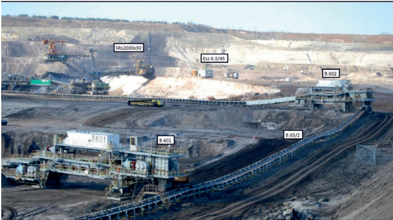
Rys. 2. Pole Belchatów. Układ technologiczny na poziomie VI w rejonie urabiania skał Fig. 2. Belchatów Field. Technological scheme on level VI in region of rock extraction
