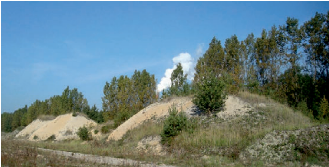
Fot. 6. Iły podwęglowe wydobyte w latach 1993-1996 i zgromadzone na składowisku północnym kopalni towarzyszących - 2011 r. Fot. 6. Under brown coal clays extracted in the years 1993-1996 and collected on the north accompanying minerals dump - 2011
