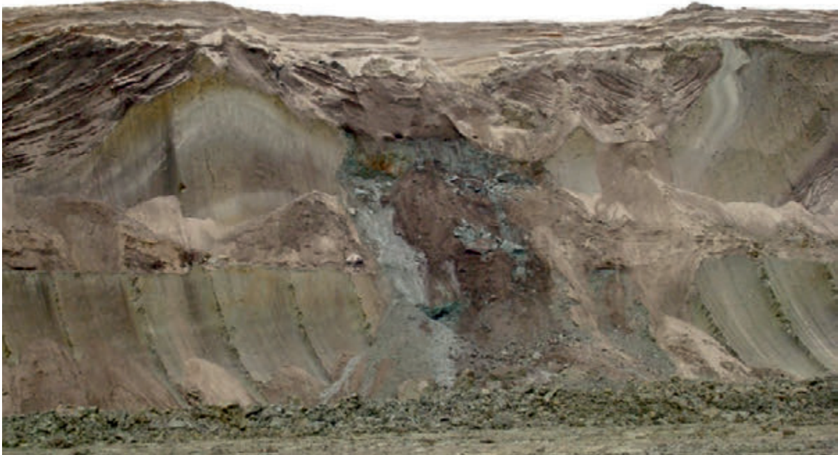
Fot. 2. Zaburzenia osadów ilastych kompleksu ilasto-piaszczystego (Pole Szczerców) Fot. 2. Dislocations of clayey-sandy rocks (Szczerców Field)
