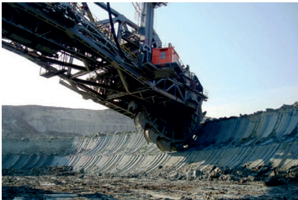
Fot. 4. Selektywna eksploatacja ilów z III poziomu Pola Szczerców Fot. 4. Selective clays extraction from III level of Szczerców Field
