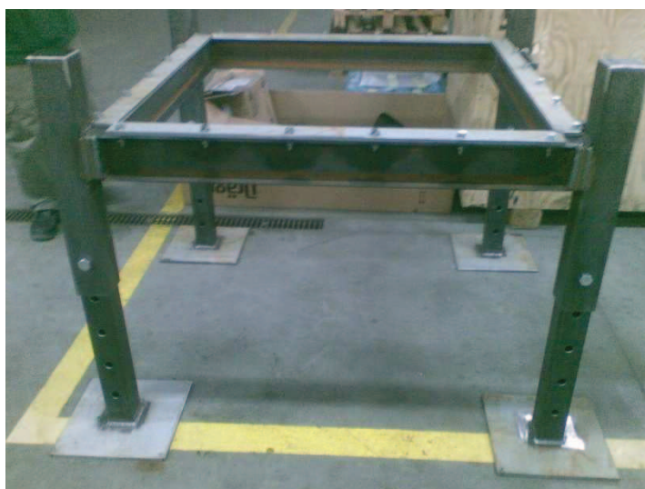
Rys. 2. Wykonane stanowisko badawcze z widocznymi elementami umożliwiającymi regulację wysokości osłony w stosunku do podłoża.
