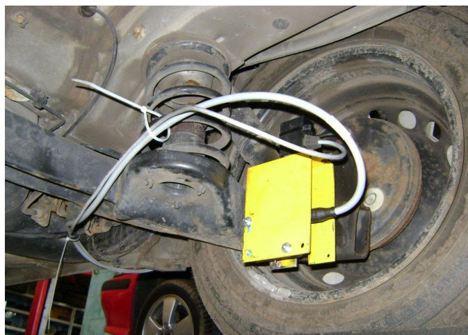
Rys. 3. Widok zestawu przetworników pomiarowych zamocowanych w pojeździe badawczym
