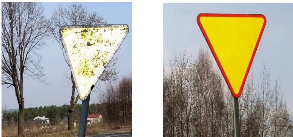
Rys. 1. Znak „A-7” w starej (lewa strona) i nowej technologii wykonania (prawa strona) Fig. 1. Road sign “A-7” in the old technology (left side) and in new design technology (right side)
