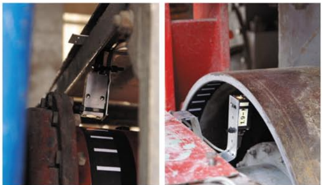
Rys. 7. Pomiarzy prędkości obrotowej, z lewej obrotów silnika, z prawej ruchu bębna hamulca przeciążeniowego
