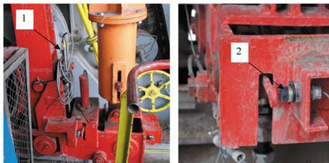
Rys. 6. Pomiar ruchu dźwigni przegubowej zwalniającej hamulec przeciążeniowy
