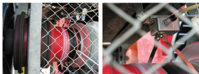
Rys. 8. Układ pomiaru momentu na wale silnika wraz z transmisją radiową mierzonego sygnału
