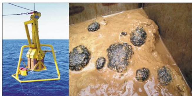
Rys. 3. Opróbowanie złoża kongrecji polimetalicznych - z lewej: przyrząd do opróbowania (czerpak skrzynkowy – boxcorer), z prawej: próbki pobrane z dna Pacyfiku [2]
