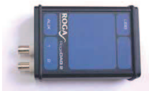
Fot. 5. Dwukanałowy rejestrator analogowo-cyfrowy RogaDAQ2
