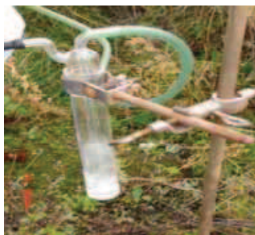
Fot. 1. Belkotka w układzie pomiarowym do pobierania dwutlenku węgla z powietrza Phot. 1. Bubbler in the sampling system for capturing of carbon dioxide from the air
