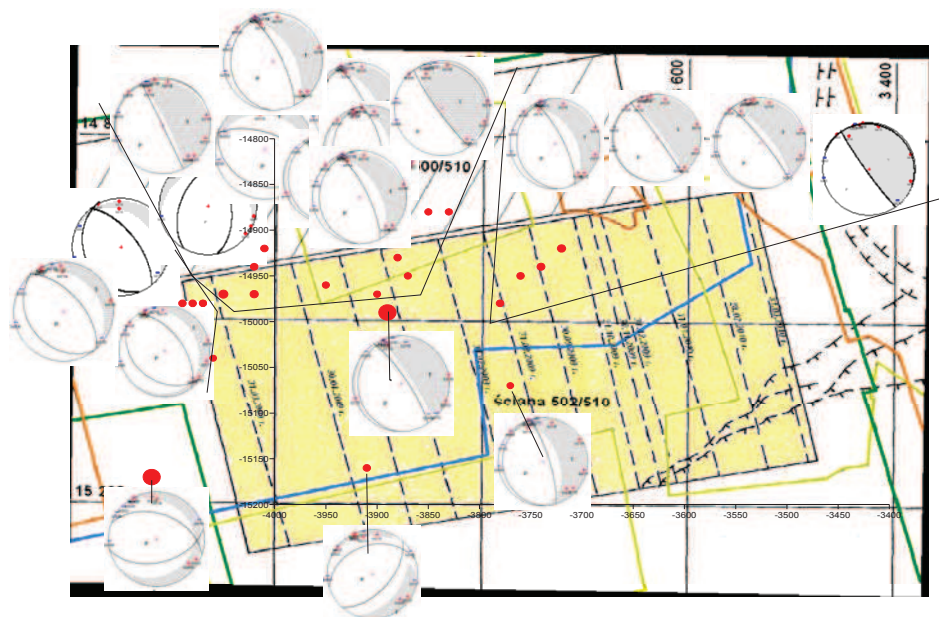
Rys. 5. Położenie ognisk wstrząsów, typu poślizgowego, które wystąpiły za frontem wraz z ich mechanizmami
