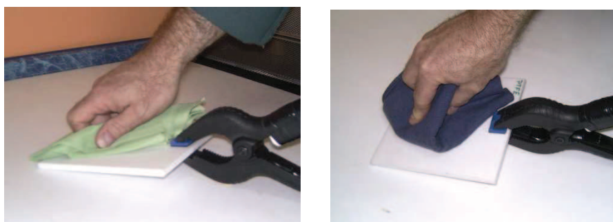
Fot. 1. Elektryzacja kontaktowo-tarciowa Photo. 1. Contact-friction electrification
