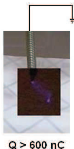
Fot. 3. Wyładowanie koronowe między naelektryzowanym materiałem a uziemionym przewodnikiem
