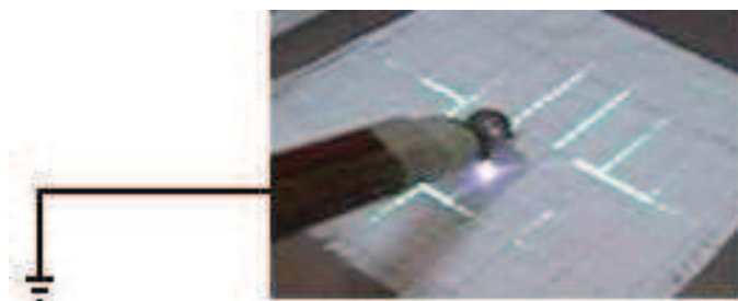
Fot. 6. Rozładowanie naelektryzowanego materiału położonego na uziemionym podłożu metalowym wskutek zbliżania uziemionej powierzchni przewodnika
