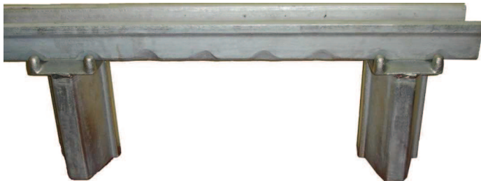
Fot. 1. Sposób posadowienia nowego kształtownika KO21 na stojakach z głowicą koronową Photo. 1. Way of placing of new KO21 section on props with a crown head
