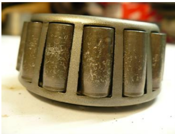
Rys. 5. Elementy toczne łożyska stożkowego z pittingiem Fig. 5. Rolling elements of bearing with pitting
