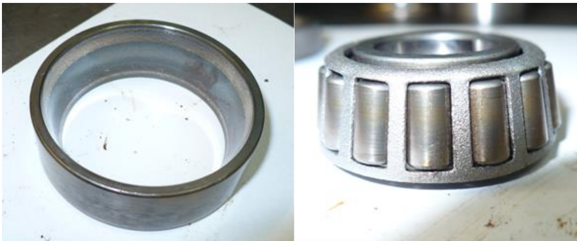
Rys. 7. Przegrzana bieżnia zewnętrzna i elementy toczne łożyska stożkowego Fig. 7. Overheated outer roller race and rolling elements of bearing
