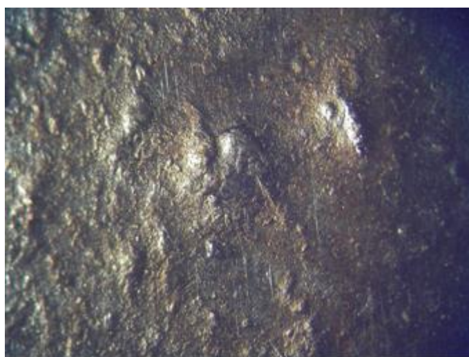
Rys. 8. Powierzchnia przegrzanej bieżni zewnętrznej łożyska stożkowego, mikroskop świetlny, powiększenie 50x
