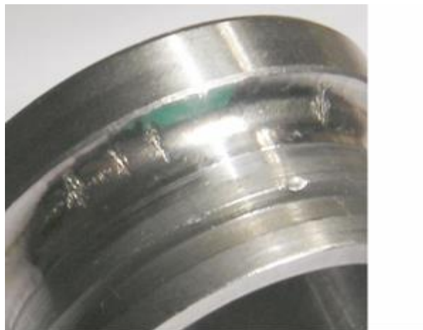
Rys. 1. Pitting na wewnętrznej bieżni łożyska kulkowego [3]
