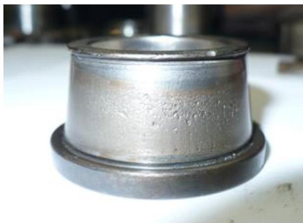
Rys. 3. Bieżnia wewnętrzna łożyska stożkowego z pittingiem Fig. 3. Inner Toller race with pitting
