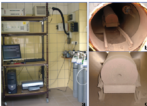
Fot. 1. Nowe stanowisko badawcze do badania gazów postrzałowych: a – stanowisko pomiarowe wraz z analizatorami gazów, b – komora wraz z moździerzem od strony wjazdu, c – moździerz w komorze od tyłu
