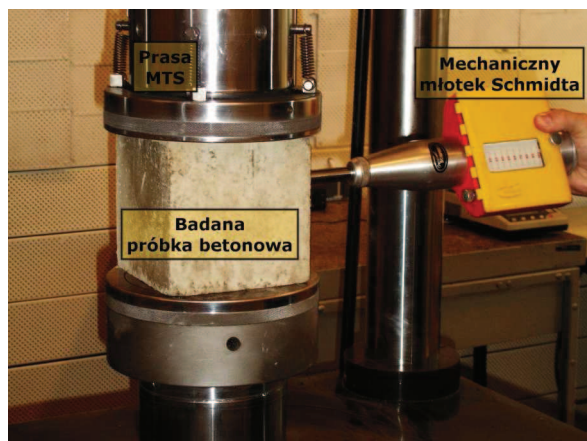
Fot. 1. Badania laboratoryjne kostkowych próbek betonowych – pomiar liczby odbicia za pomocą młotka Schmidta Phot. 1. Laboratory testing of cube concrete samples – measurement of the number of rebounds using the Schmidt hammer
