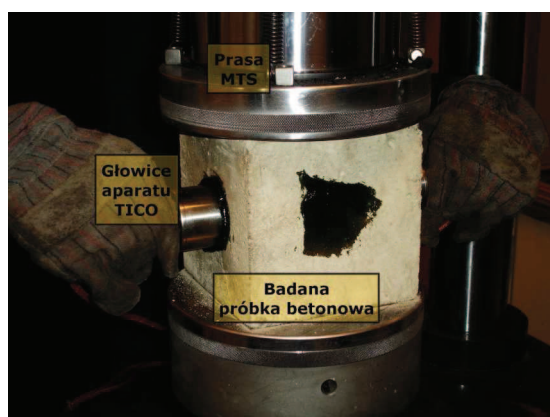
Fot. 2. Badania laboratoryjne kostkowych próbek betonowych – pomiar czasu przejścia fali ultradźwiękowej za pomocą aparatu ultradźwiękowego TICO Phot. 2. Laboratory testing of cube concrete samples – measurement of ultrasound wave transition time using TICO Ultrasonic System
