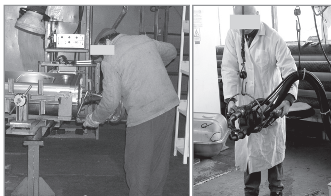
Fot. 2 Typowa pozycja ciała pracownika obsługującego zgrzewarkę rezystancyjną podwieszaną
