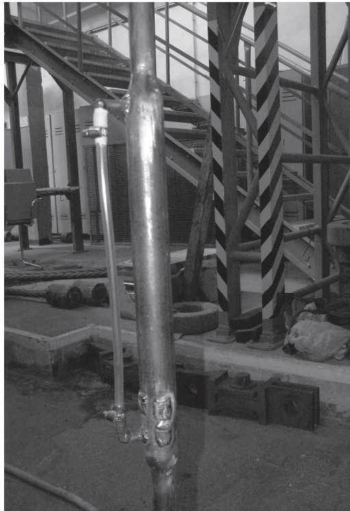
Fot. 5. Amortyzator powietrzno-cieczowy zabudowany na rurociągu modelowym Phot. 5. Oleo-pneumatic shock absorber built-up on a model pipeline
