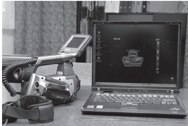
Fot. 2. System termowizyjny z wykorzystaniem kamery typu ThermaCAM P65
