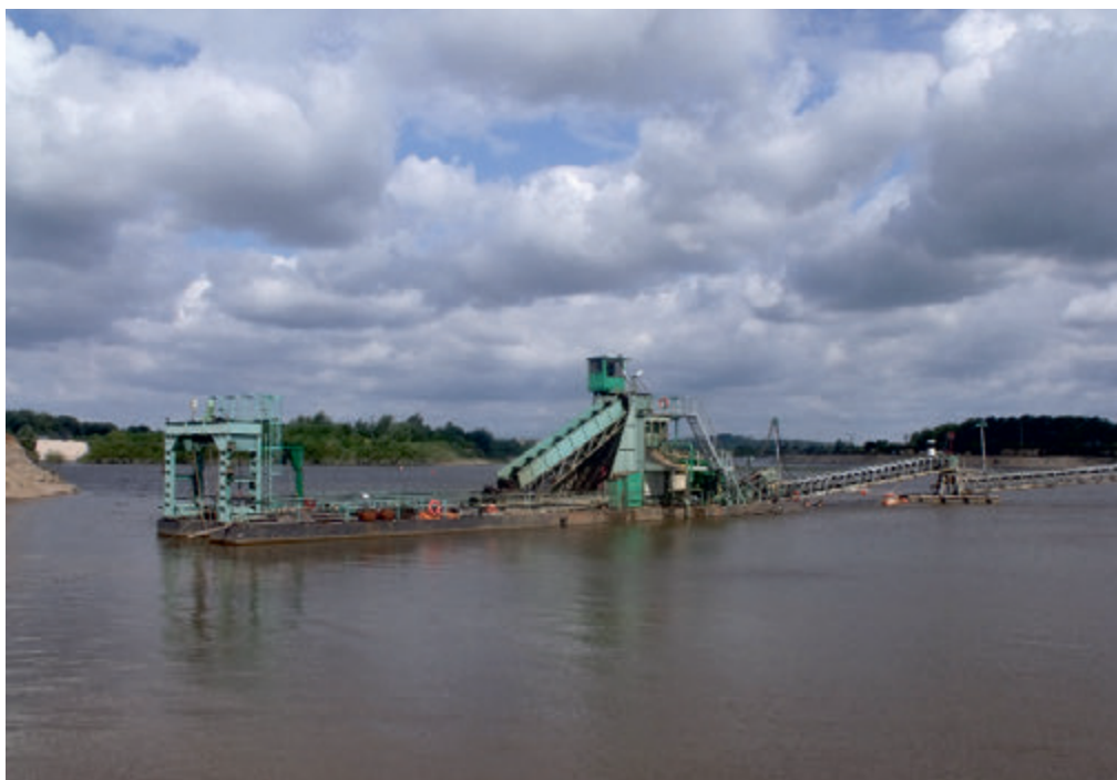
Fot. 1. Koparka wieloczerpakowa KS160 firmy Röhr eksploatująca złożo Rakowice Photo. 1. The KS160 multi-bucket dredger excavator from Röhr in operation at the 'Rakowice' bed
