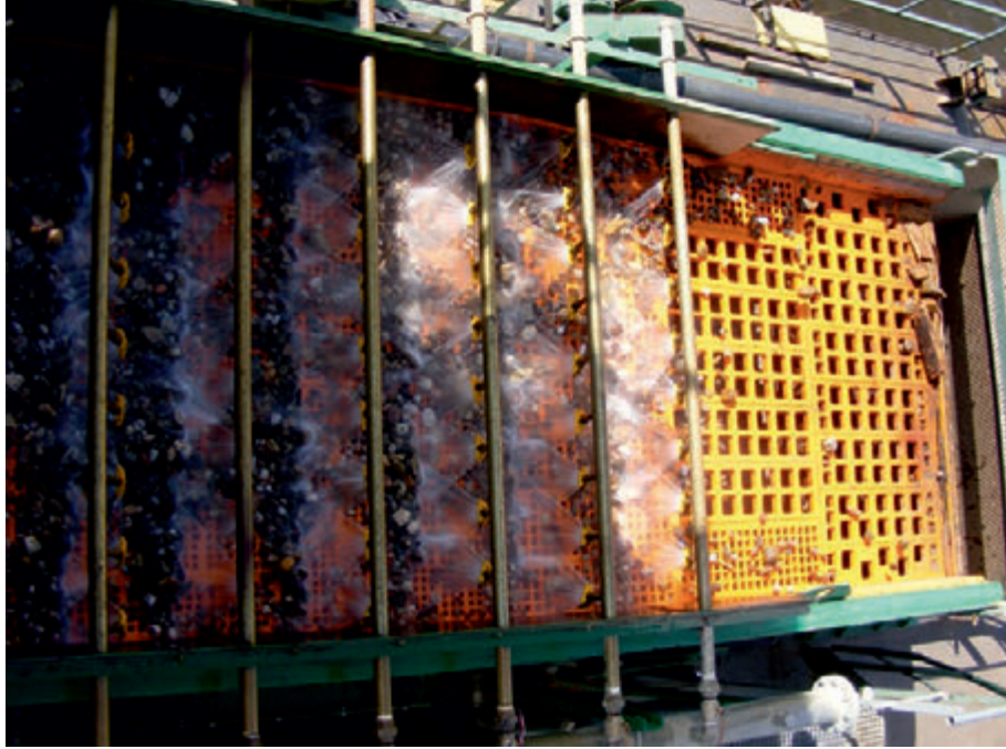
Fot. 3. Górny pokład przesiewacza koparki KS 160 Photo. 3. The top screen of the KS 160 dredger excavator
