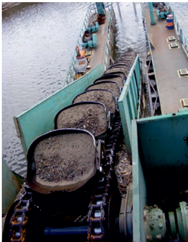
Fot. 2. Czerpaki koparki wieloczerpakowej wynoszące urobek spod wody Photo 2. Buckets of a multi-bucket dredger excavator designed to excavate minerals from underwater beds
